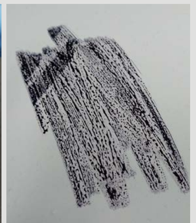
Eposilan PLUS ist mit einem Erstschutz ausgestattet. Einige Faserstifte zeigen kaum Haftung und können somit leicht entfernt werden.
