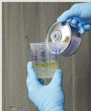
Die neue Formel von Eposilan PLUS hat nun das Mischungsverhältnis 3:1 (Harz/Härter, Volumenteile)
