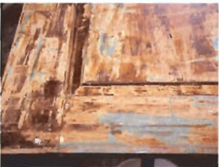
Zweifelhafter Erfolg: fleckige Oberfläche, bei näherem Hinsehen entdeckt man Farbnester Das Ergebnis im Vergleich: Klarer Vorteil für den CKW-freien Abbeizer (untere Türhälfte)
