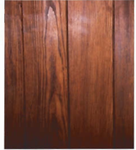
Die Fläche sieht schon in nassem Zustand gut aus. Nach Trocknung ist das Holz heller, und die gute Oberflächenquali- tät ist deutlich zu sehen
