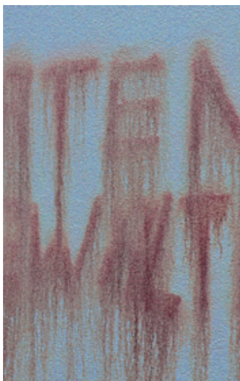
Das Graffiti läuft während der Entfernung einfach vom neuartigen Schutzlack m.a.c.s Eposilan ab.
